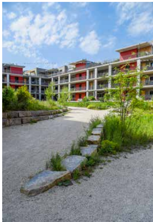
Links: Mergelwege erschliessen das leicht abfallende Gelände. Auf eine Begradigung des Hangs hat man verzichtet, um den trennenden Charakter einer Terrassierung zu vermeiden. Rechts: Grosse rohe Steinquadern stabilisieren das Erdreich.
